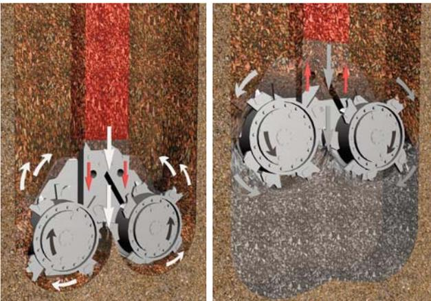
*Le terrain est détruit lors de la perforation. Les produits d'excavation sont déplacés vers le dessus de la tête de coupe. Lors de la remontée, le mouvement de la machine déplace le mélange du dessus vers le dessous de la machine. Un liant est alors injecté et mélangé.*
